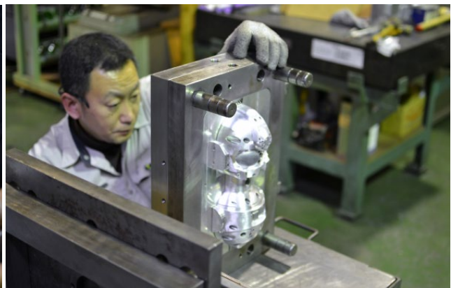
金型組付け確認
