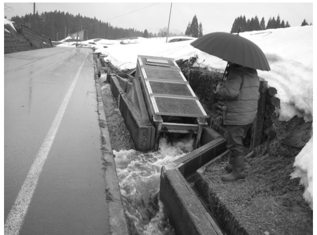
小水力発電 (B) [らせん型。500ワット。落差80cm程度]
